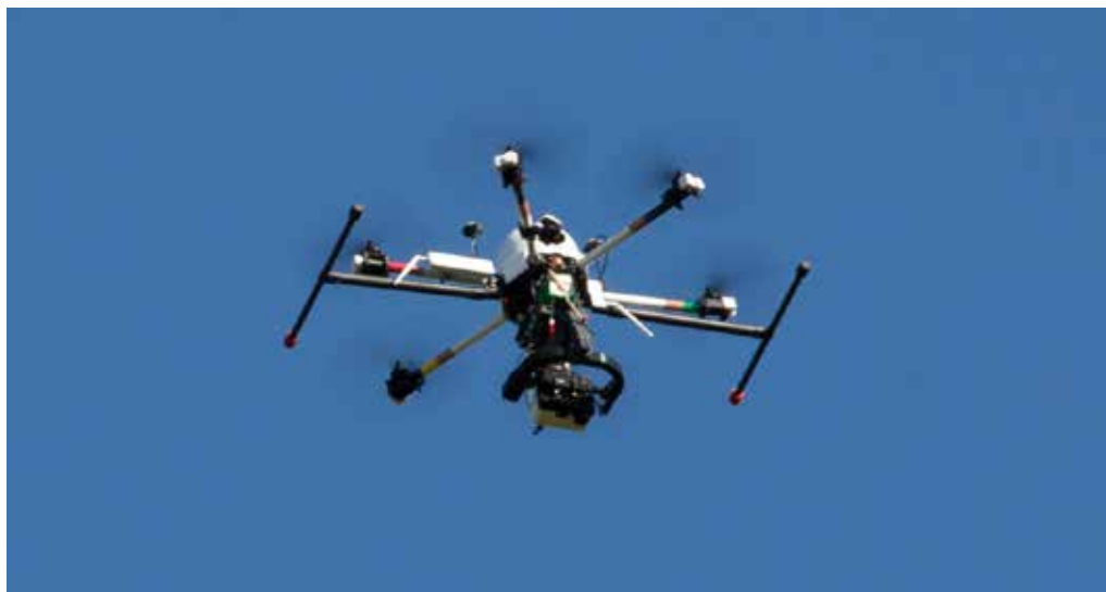
Hexakopter mit Wärmebildkamera (Foto: Ingo Janek)
